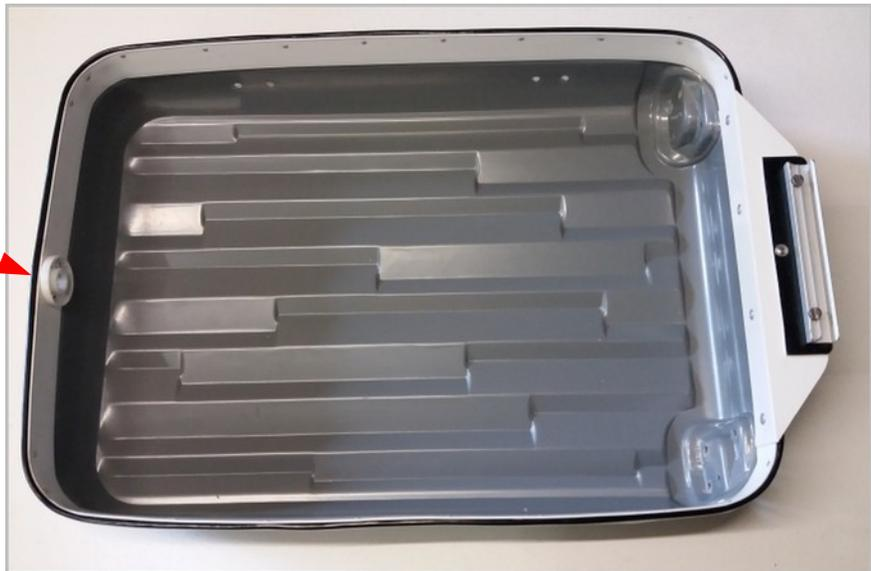
9) La fixation du couvercle côté robinets se fait avec l'élastique d'origine du recycleur.
